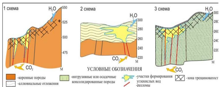
Рис. 5.1 Схемы формирования месторождений углекислых вод Приморской области (20 м), распространенные над выходом активной части разлома, подводящего углекислый газ.
