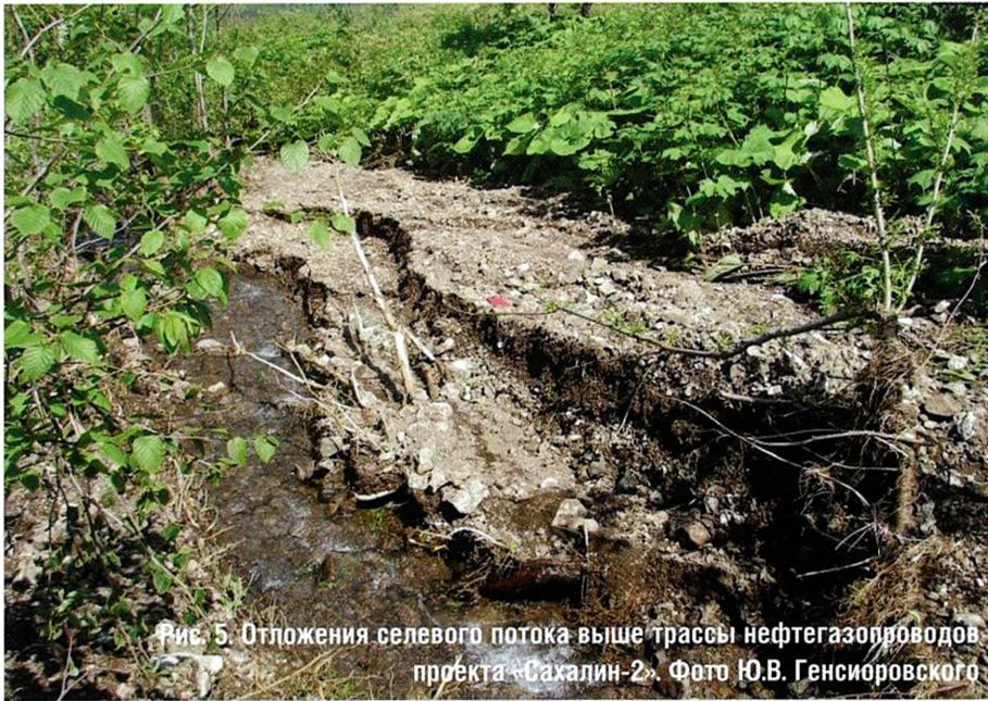
Рис. 5. Отложения селевого потока выше трассы нефтегазопроводов проекта «Сахалин-2». Фото Ю.В. Генсировского
