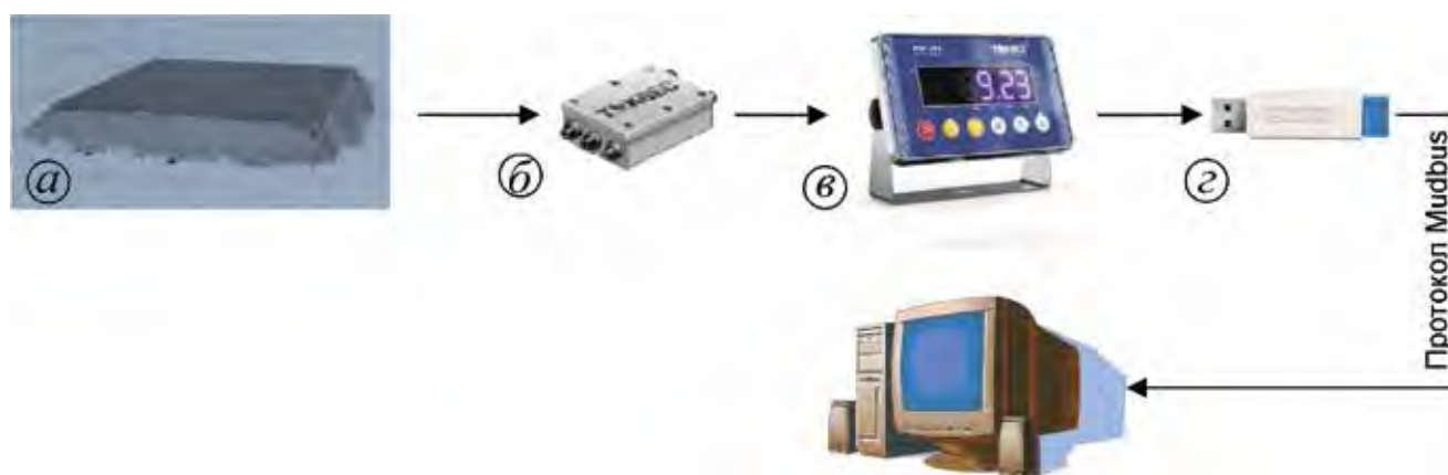
Рис. 1. Схема системы дистанционного мониторинга снеговой нагрузки (а–г – см. текст)
