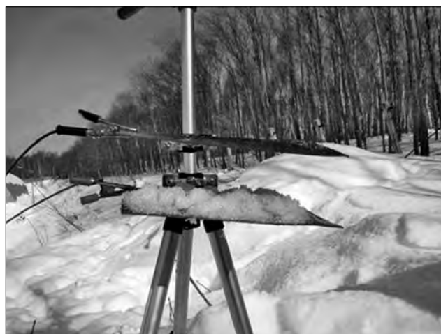
Рис. 4. Установка для экспериментов по электризации ледяных кристаллов в искусственном электрическом поле (фото Н.А. Казакова).
