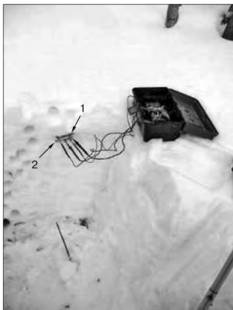
Рис. 3. Измерение электрической емкости снежного слоя (Южный Сахалин, фото Н.А. Казакова).
