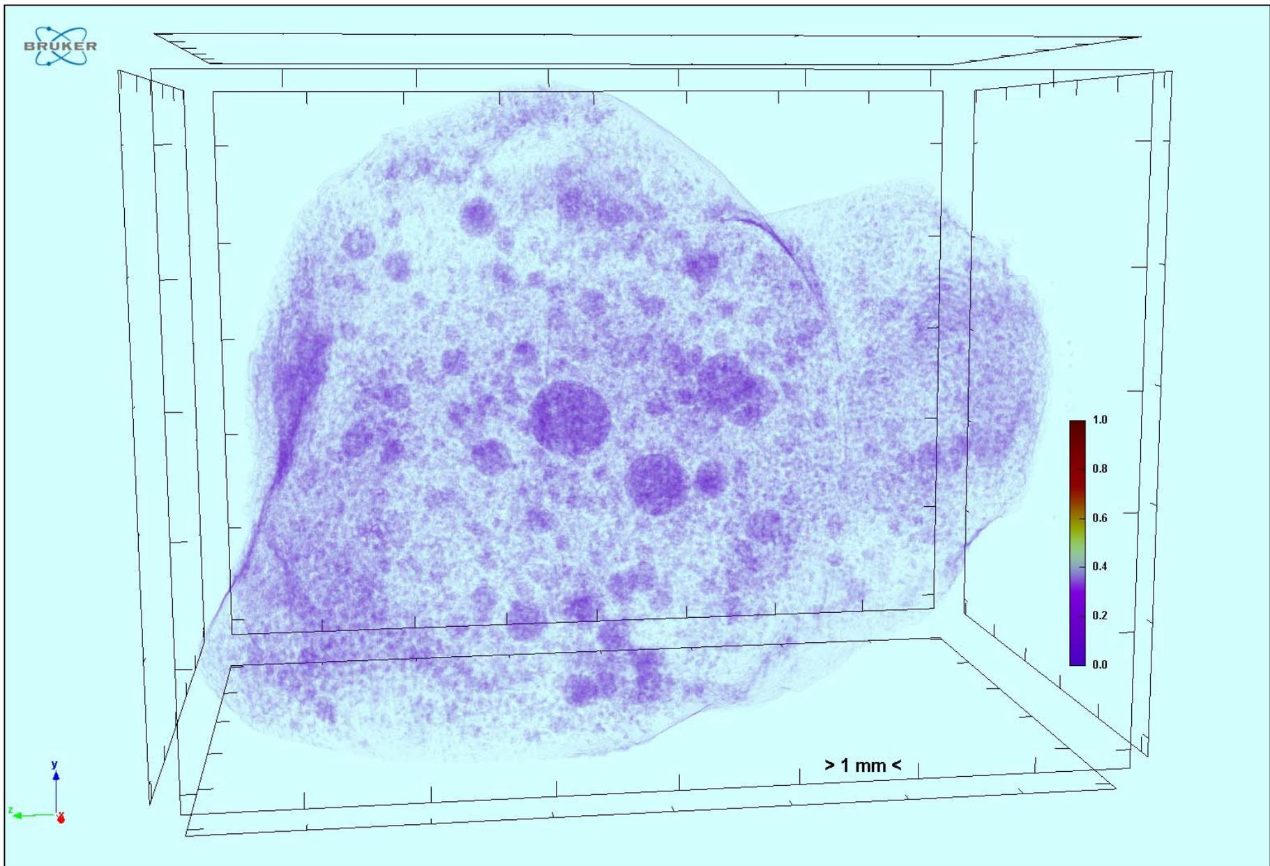
*Визуализация пор в режиме полупрозрачности*
