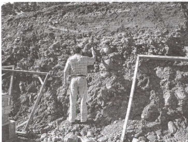
Рис. 1. Селевые отложения р. Рогатки (Сусунайский хр.) в г. Южно-Сахалинске. Выделяется не менее 3 грязекаменных селей: 1872 г.; 30е – 40е годы XX в. Фото Генсиоровского Ю.В.
